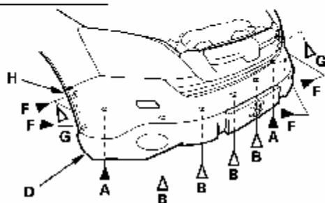
3. 拆下固定前保险杠侧装饰件(H)的螺钉(F)与卡夹(G)。
