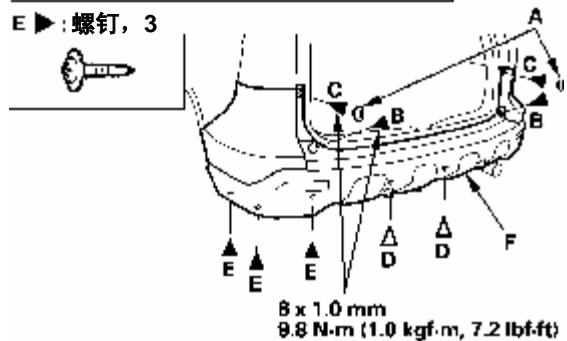
3. 推动轮罩拱部位的后保险杠(A), 并将其从侧垫片(C)的卡钩(B)上拆下。
