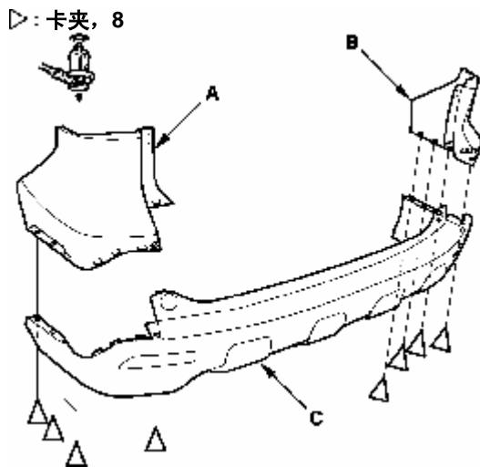
3. 拆下卡夹(A)与螺钉(B)，然后从下后保险杠面(D)上拆下后保险杠下装饰件(C)。
