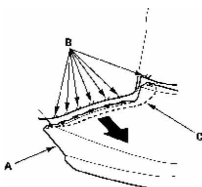
4. 在助手的帮助下, 将轮罩拱部位从侧垫片(A)上拆下的同时, 推动后保险杠(B), 从上支架(D)上的卡钩(C)上松开保险杠。如果配备, 断开后保险杠副线束插头(E)。
