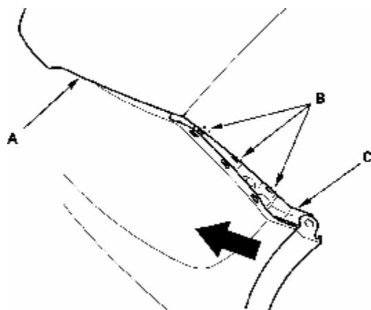
5. 在助手的帮助下，将轮罩拱部位从侧垫片(A)上拉开的同时，推动前保险杠，从中间顶梁(C)卡钩(B)上松开保险杠。
