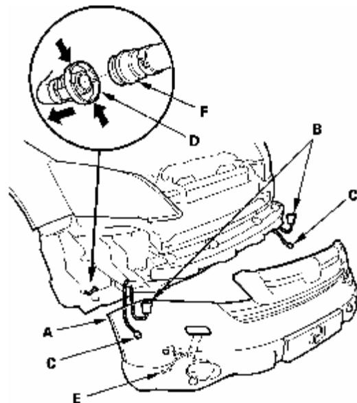
7. 对于某些车型：夹紧固定器(D)的同时，拉车丁内衬清洗器管(E)，并将其从清洗器电机喷嘴(F)上断开。
